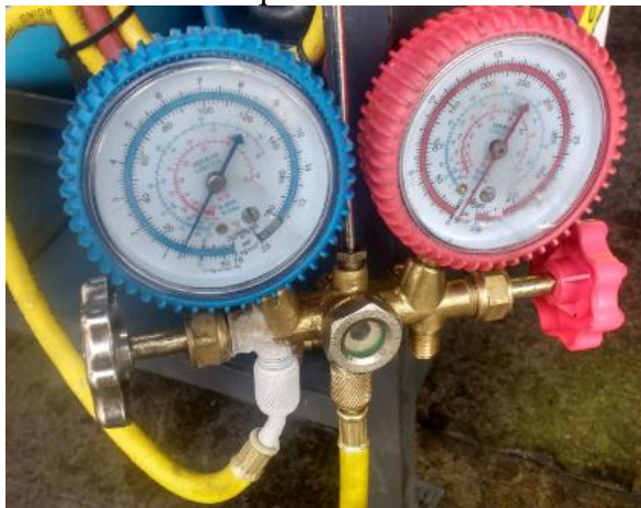
Figura 16: Momento que a vazão foi limitada a 10 PSI
