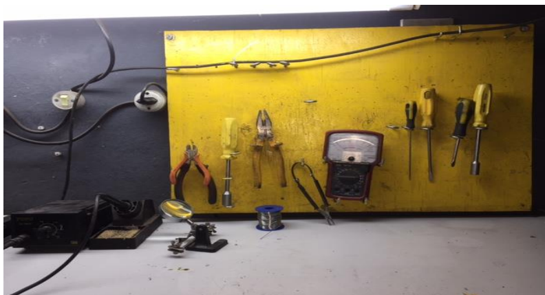
Figura 6 – Mesa de soldagem de componentes eletrônicos
